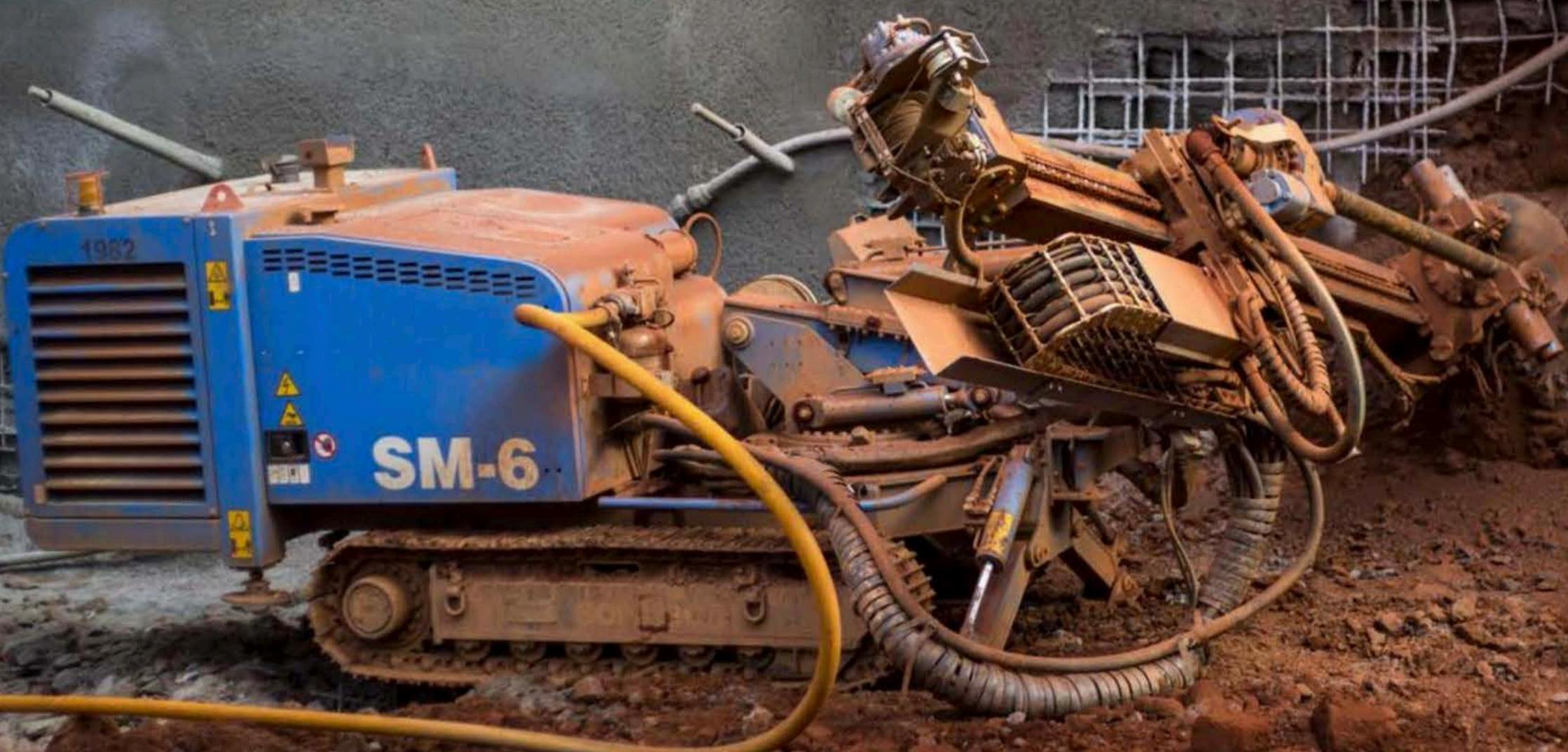
Multifunzionale e dinamica in ogni contesto di lavoro, la perforatrice SM-6 ha la prerogativa di un'antenna modulare dal design unico per di passare facilmente da 1.400 mm a 3.400 mm di corsa, con quattro diverse configurazioni
