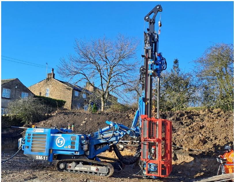
offrire la soluzione ideale rispetto al tipo di lavorazione richiesta. Il mast è disponibile in differenti lunghezze con corsa compresa tra 1850 mm e 4200 mm, allestite con un tiro spinta a motoriduttore in grado di trasmettere una forza di 96 kN. La SM-11 monta un motore Cummins F3.8 da 115 kW (154 HP). Grande versatilità anche per le movimentazioni grazie al cinematismo con zoom telescopico e giunto a 90°, come nella versione in esposizione al Bauma, e opzionalmente con ralla a 360°.
