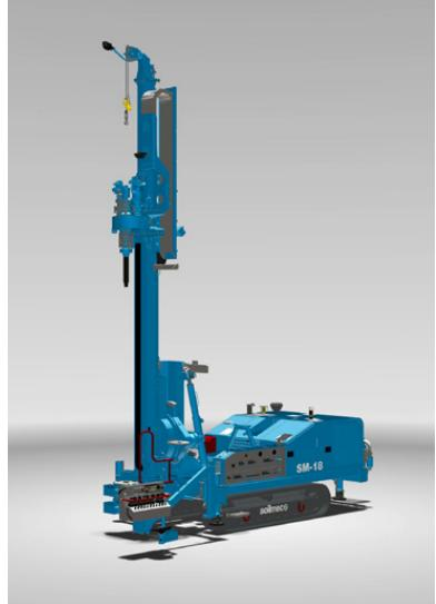
con il 6,7 litri di Cummins e nuovo kit Jet Grouting in grado di eseguire un trattamento in singola passata di 27,3 metri. Nella versione esposta al Bauma, la macchina era allestita con un caricatore a 10 aste, che consente di perforare sino a una profondità di 66 metri in totale sicurezza, e con la testa rotary Soilmec HR21GV caratterizzata da un'elevatissima velocità di rotazione fino a 446 rpm.
