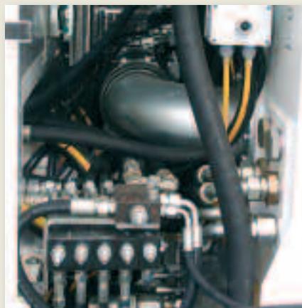
Il sistema di controllo dell'impianto idraulico garantisce movimenti di perforazione rapidi e precisi allo stesso tempo
