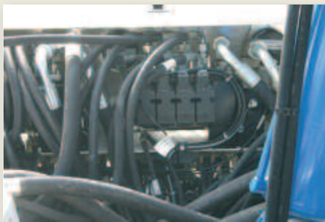
L'impianto idraulico, di tipo load sensing, è dotato di pompe a pistoncini in grado di assicurare una portata di 532 l/min
