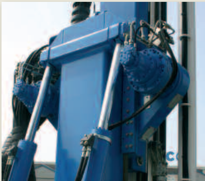
Il sistema a motoriduttori della SM-18 consente la rotazione continua dell'antenna in tutte le condizioni di inclinazione
