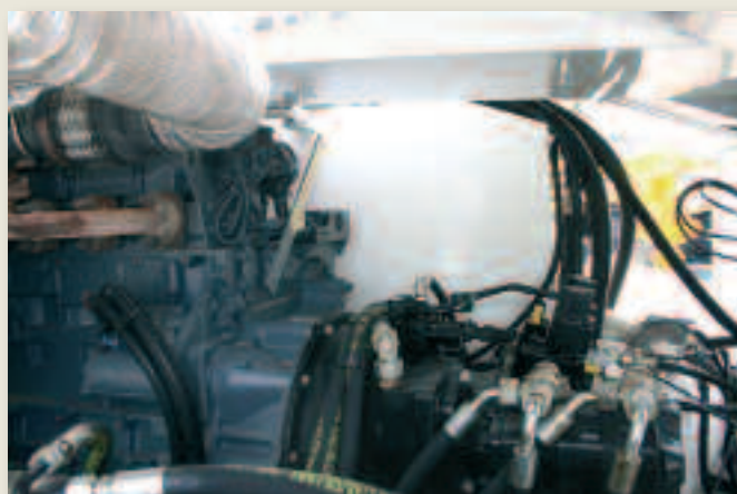
La SM-18 è equipaggiata con un motore Deutz TCD2013-L06 2V Tier 3 della potenza massima di 176 kW a 1.900 giri/min
