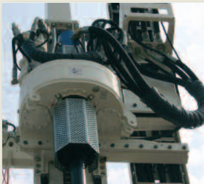
La SM-18 è dotata in allestimento standard di una rotary caratterizzata da una coppia massima variabile da 1.175 a 3.659 daNm, a seconda delle versioni
