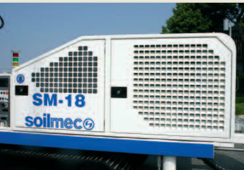
Le ampie cofanature della macchina consentono un agevole accesso ai componenti interni
