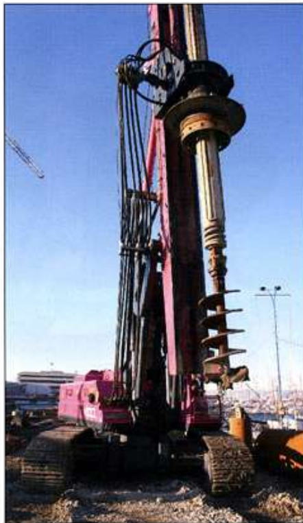
La R 930 consente di realizzare pali trivellati a secco o con fluidi di perforazione, con infissione ed estrazione di tubi di rivestimento con o senza morsa, pali ad elica continua, pali a circolazione inversa e pali secanti con doppia testa
