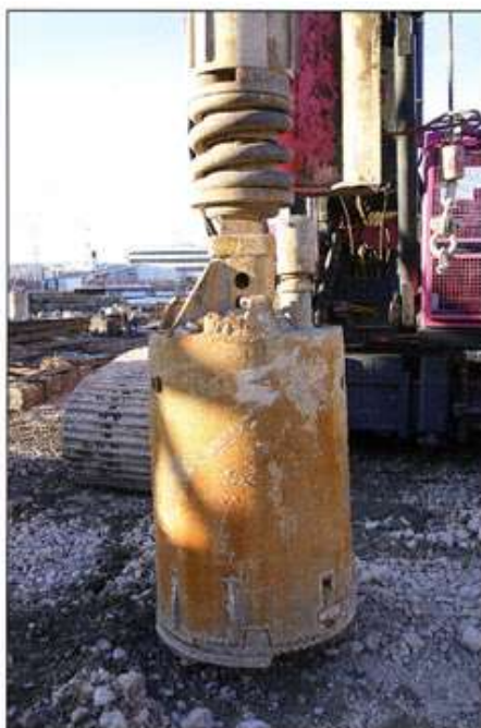
A seconda della natura e consistenza del terreno, la R 930 può utilizzare un normale bucket da scavo o una punta a elica
