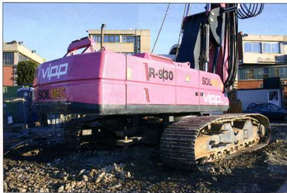
La macchina è dotata di sottocarro a cingoli espandibili con sistema a sfilii coassiali
