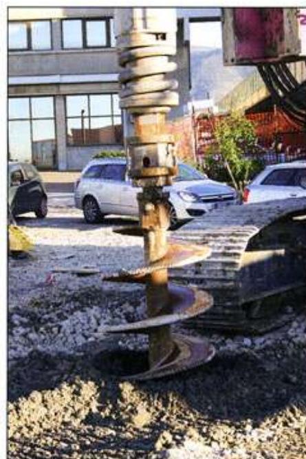
A seconda della natura e consistenza del terreno, la R 930 può utilizzare un normale bucket da scavo o una punta a elica
