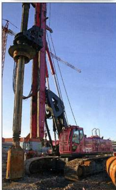
Sulla R 930 sono installabili appositi kit per l'esecuzione di pali a elica continua, pali secanti, pali costipati e per circolazione inversa
