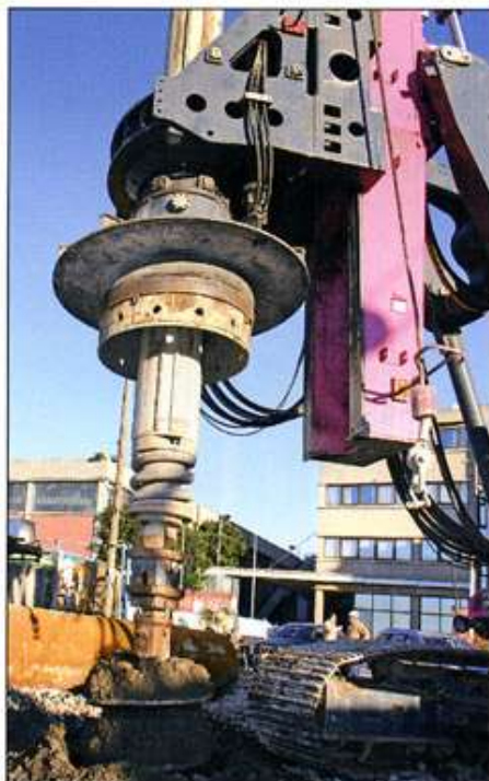
La testa di rotazione, a tre velocità di perforazione e una velocità di scarico veloce, consente di raggiungere la coppia massima per ciascuna delle suddette velocità
