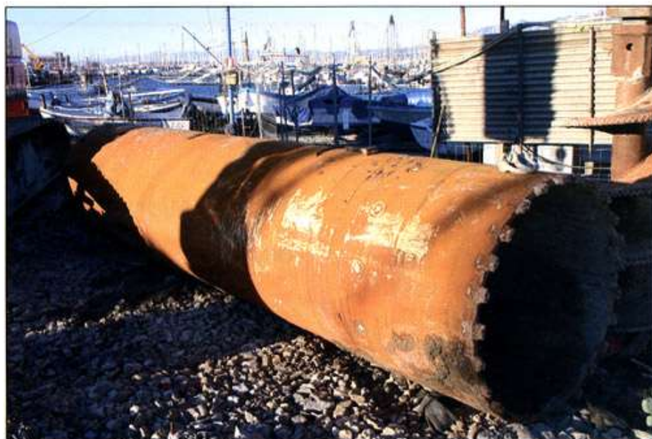
Il tubo - forma utilizzato per l'esecuzione dei pali
