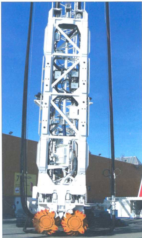
Vista general de la unidad de fresado Soilmec H-8.
