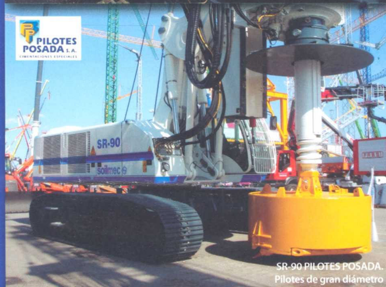
SR-90 Pilotadora Gran Diámetro 3000 mm. prof. 77 m. Unidad de fabricación n.º 3000 RODIO
