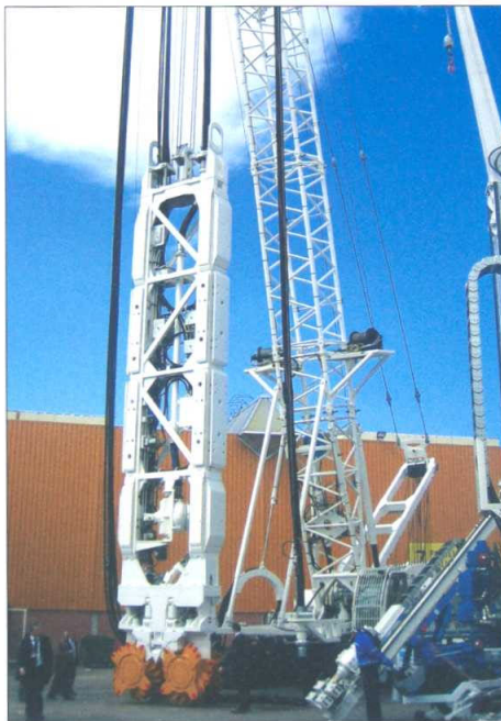
Sobre el stand sobresalía la hidrofresa H8 montada sobre grúa SC120 versión Cougar.
