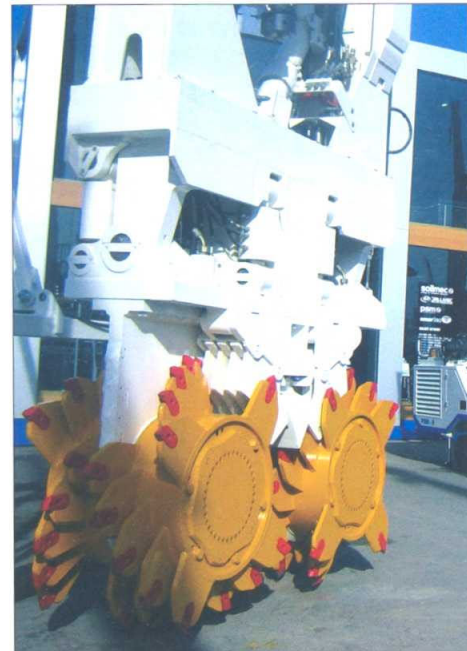
Detalle del tambor de corte tipo diente para uso en distintas aplicaciones.
