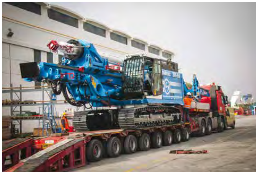
LA PERFORATRICE SOILMEC SR-65 EVOLUTION È MOLTO COMPATTA E CIÒ NE AGEVOLA ANCHE IL TRASPORTO
