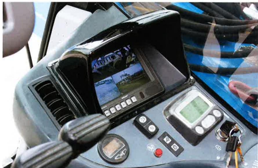
aziendale: la cabina, per esempio, è stata ridisegnata per incrementare il comfort, puntando su larghezza, facilità di accesso, visibilità ed ergonomia; il software DMS (Drilling Mate System) agevola l'operatore e, non da ultimo, una serie di dotazioni di sicurezza gli consentono di lavorare in totale tranquillità.
