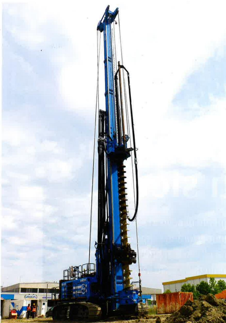
Trevi si è occupata delle opere di fondazione dell'enorme (120x65m) cella di conservazione, che ha richiesto un consolidamento del terreno mediante 486 pali, realizzati, appunto, dalla perforatrice Soilmec SR-125 HIT in configurazione CFA (tecnologia elica continua).
